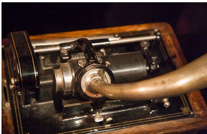
Figura 8: fonógrafo de Edison [ca. 1900], detalhe do cilindro de gravação.
