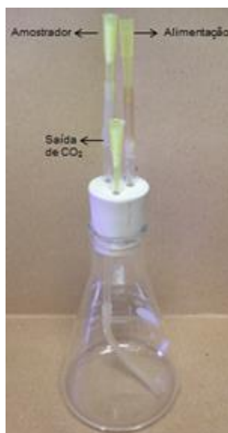
Figura 5 - Reator utilizado nos ensaios de fermentação em batelada alimentada. Erlenmeyer de 250 mL vedado com rolha de borracha contendo três furos, sendo essas para alimentação, amostrador e saída de CO 2 .
