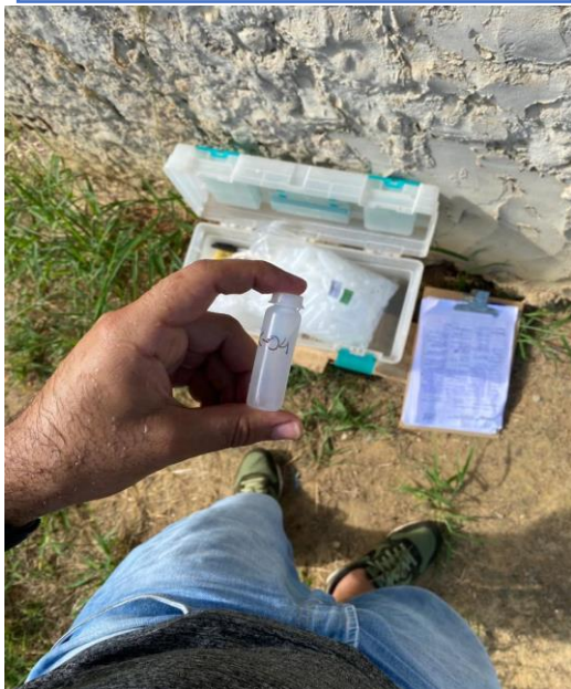
Figuras 5 - Amostra de água coletada e acondicionada, registro em planilha com data/hora
