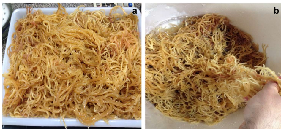
Figura 14. Exemplo do aspecto visual da biomassa de K. alvarezii após o pré-tratamento com KOH 6% (%massa/volume). (a) Amostra não tratada. (b) Amostra após um o pré-tratamento com KOH 6% (%massa/volume). Ambas amostras se referem a cepa verde do nível B.
