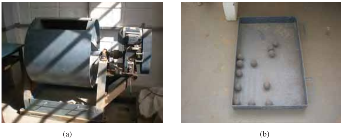
Figura 20. Moinho utilizados: a) Moinho de bolas da marca Los Angeles e b)12 esferas de aço utilizadas dentro do moinho.
