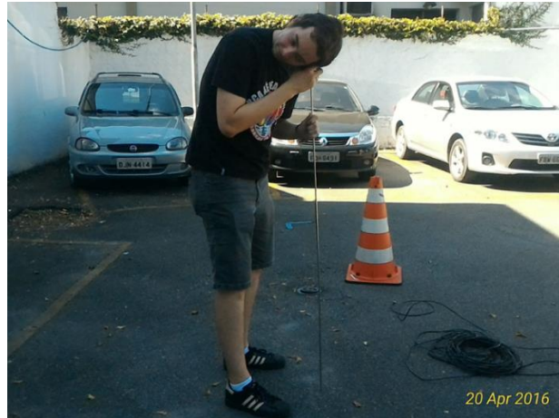
Figura 1.4- Utilização da haste de escuta para a detecção de vazamentos.
