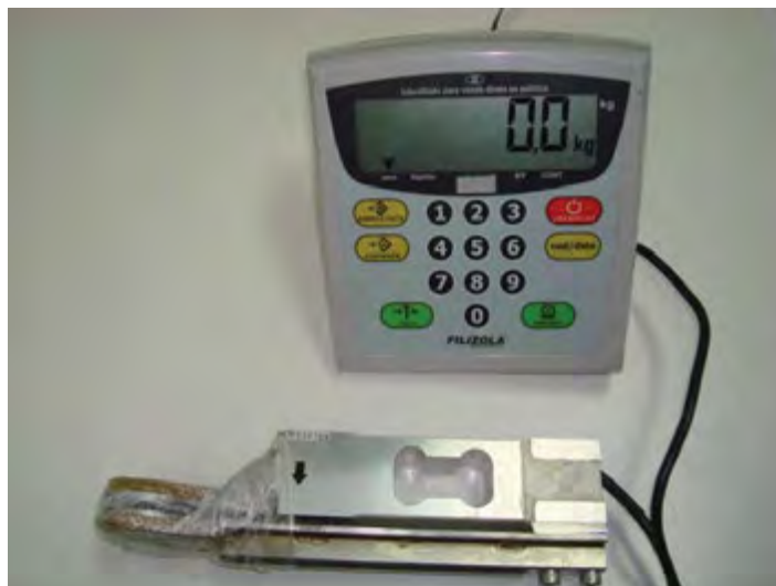
Figura 1 - Transdutor de força de mordida: célula de carga com área de mordida acoplada e indicador digital
