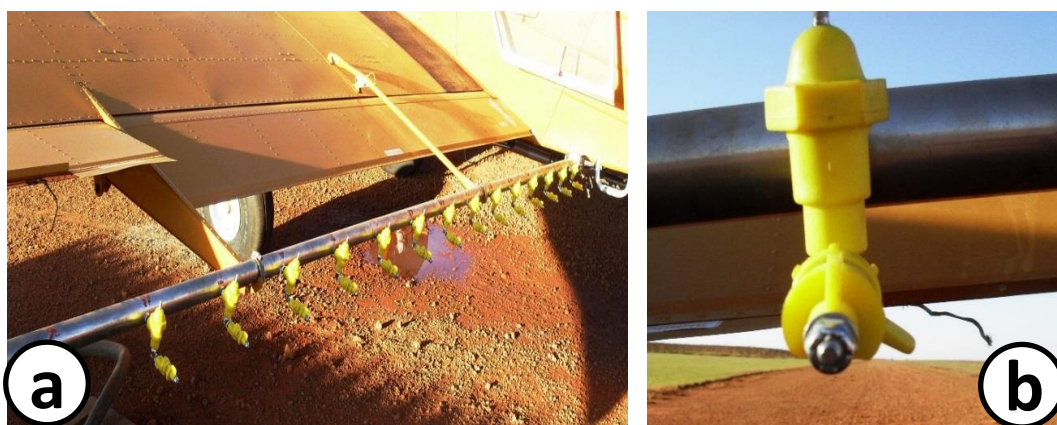
Figura 3. Pontas CP na asa esquerda da aeronave, total de 14 pontas (a) e detalhe da ponta CP com as regulagens das alavancas (b)
