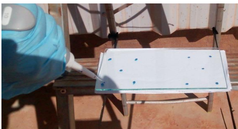
Figura 12. Método de avaliação da degradação do corante em lâmina de vidro
