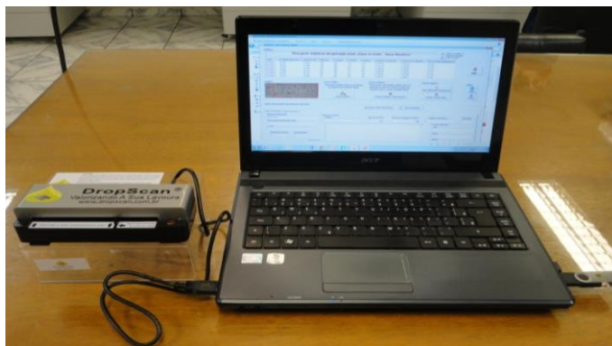
Figura 8. Scanner modelo DropScan® conectado ao computador para as análises dos papéis hidrossensíveis
