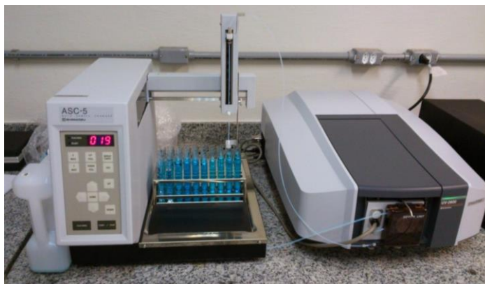
Figura 11. Espectrofotômetro utilizado para as leituras das amostras
