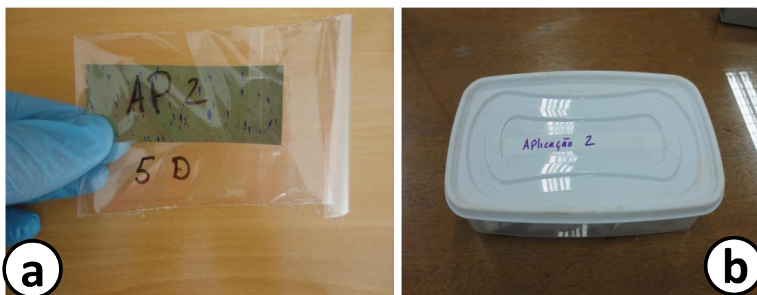
Figura 7. Papel hidrossensível após a aplicação (a) e recipiente de plástico para o armazenamento dos papéis (b)
