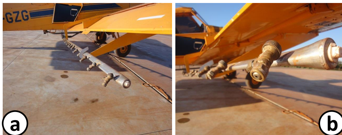
Figura 1. Detalhe da barra de aplicação (a) e dos bicos com as pontas D8-45 (b)
