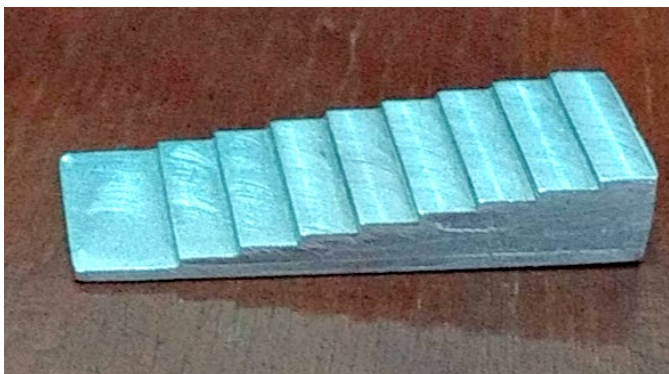
Figura 4 - Escada de alumínio com nove degraus, liga ABNT 6063.
