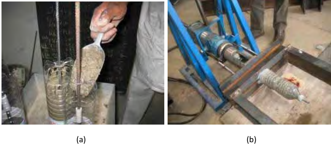
Figura 11 - (a) Preenchimento do corpo-de-prova de garrafa PET; (b) Ensaio de arrancamento APULOT.
