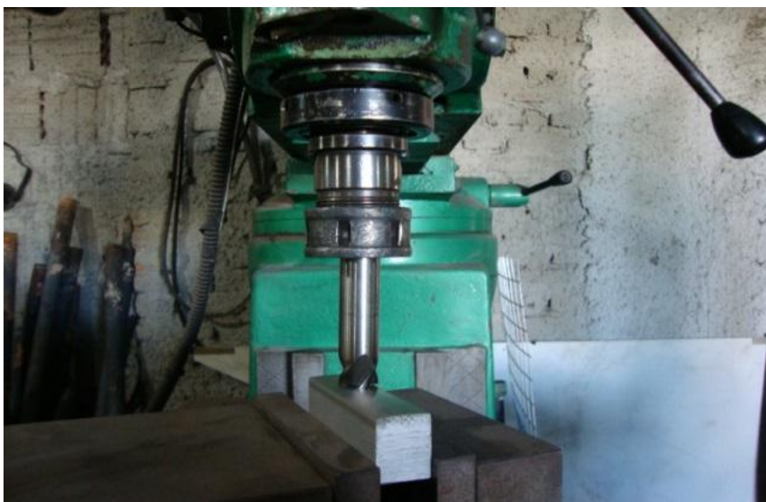
FIGURA 14 - Imagem fotográfica da frezadora utilizada na confecção da escada de alumínio.
