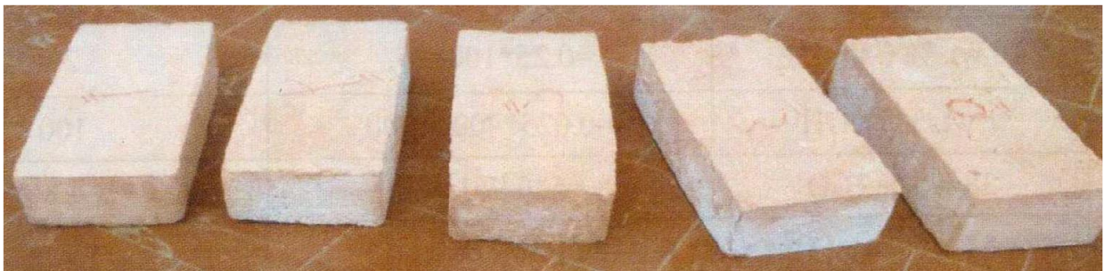
Figura 2 – Bloco geopolimérico utilizando resíduos de poeira cerâmica
