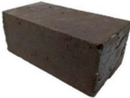
Figura 4 – Tijolo alcalino-ativado feito com escória de alto forno
