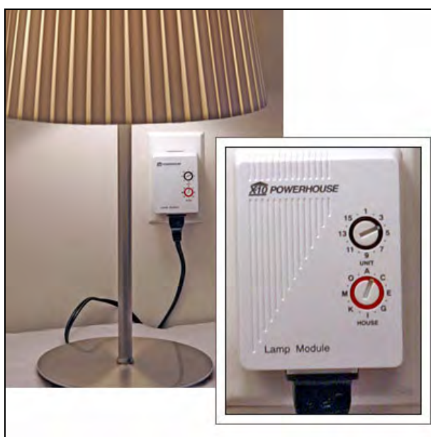
Figura 3: Receptor do sistema X-10, marca PowerHouse
