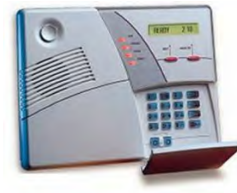
Figura 2: Controlador central para equipamentos X-10
