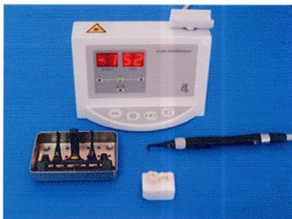
FIGURA 4 - Aparelho de laser de diodo – DIAGNOdent – calibrador e ponteiros A e B (interproximal e oclusal)
