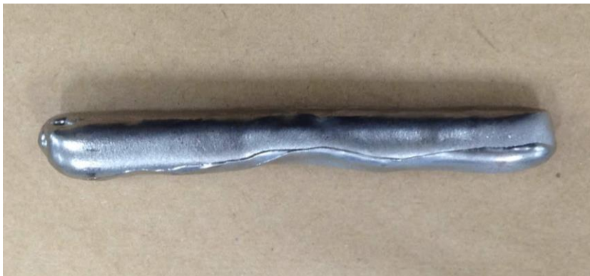
Figura 2 - Liga metálica quaternária Ti-35Nb-7Zr-5Ta em lingote, após fundição dos elementos.
