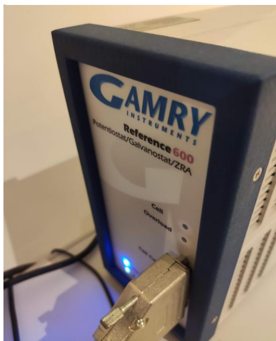
Figura 7 - Equipamento de ensaio de corrosão Potenciostato/ Galvanostato
