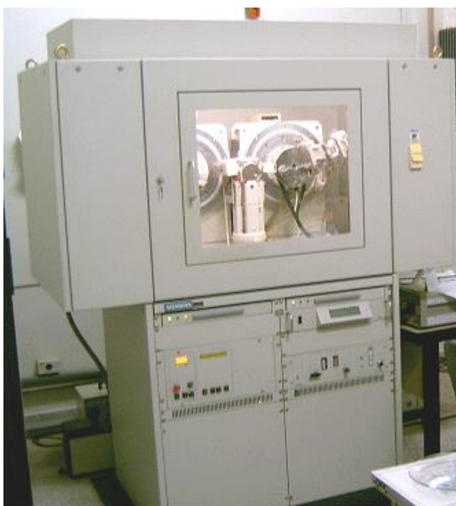
Figura 6 - Equipamento de Difração de energia dispersiva de raios X.
