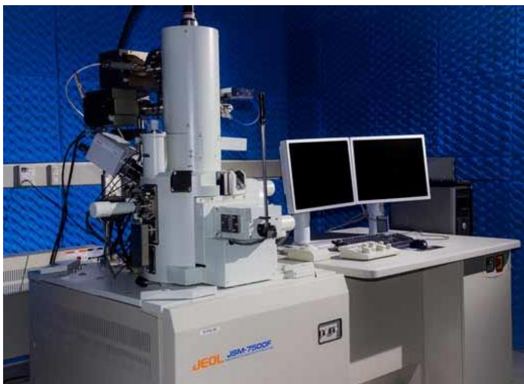
Figura 5 - Microscópio eletrônico de varredura com canhão de emissão de campo (MEV-FEG).
