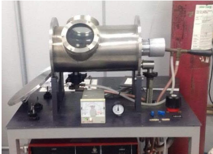
Figura 1 - Forno de fundição á arco voltaico, controlado por bomba a vácuo e fluxo de argônio.
