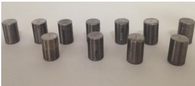
Figura 3 - Liga metálica quaternária Ti-35Nb-7Zr-5Ta após usinada e cortada.
