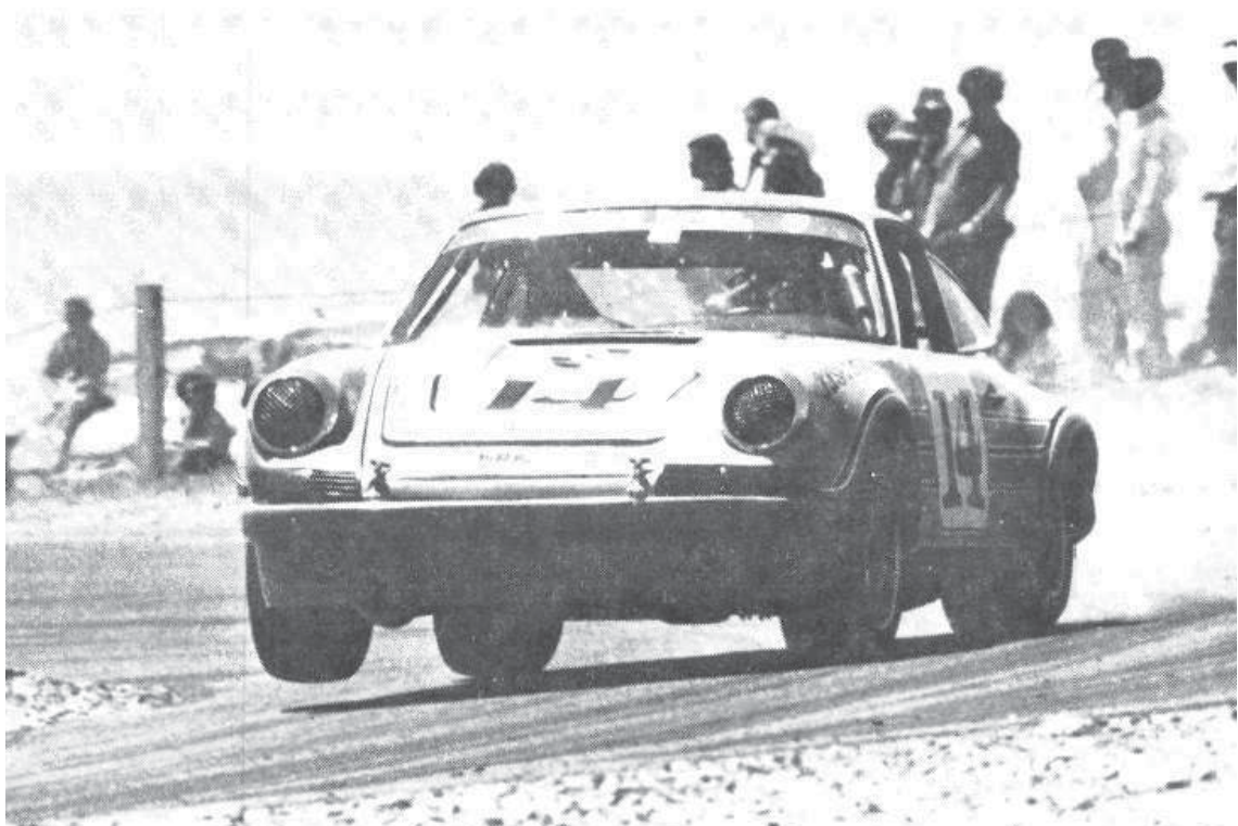
Figura 39: Carro sobre 3 rodas por consequência do balanço incorreto entre a rigidez torcional das suspensões dianteira e traseira. (PUHN, 1976).
