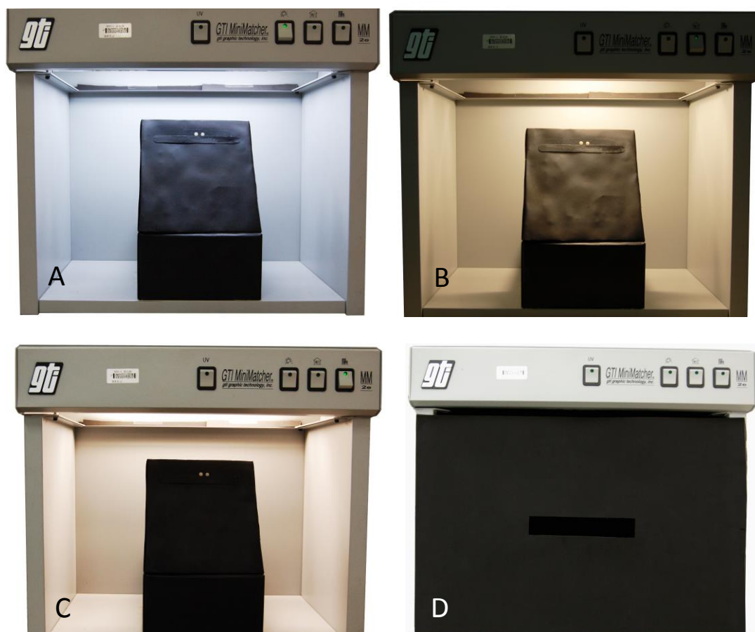
Figura 11 – Amostras em cabine de Luz sendo testadas. A - Luz D65; B- Luz Incandescente; C - Luz Fluorescente; D - Cabine com direcionador de visualização em ângulo de 60^{\circ} .
