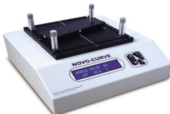
Figura 5 – Equipamento utilizado para determinação do brilho superficial – Novo-Curve (Rhopoint TM, East Sussex, England).
