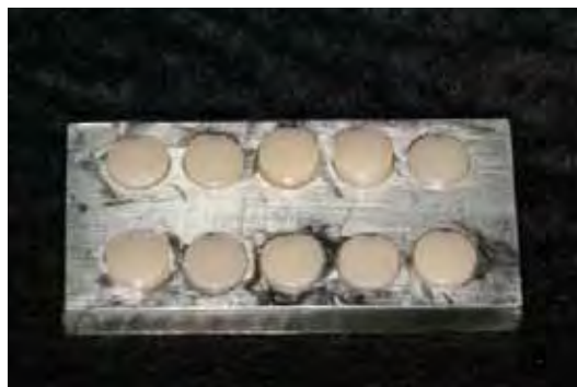
FIGURA 4 – Matriz metálica com os cdp em posição para leitura da rugosidade.
