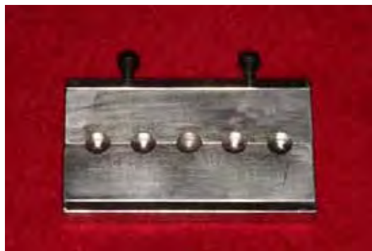
FIGURA 1 – Matriz metálica bi-partida.
