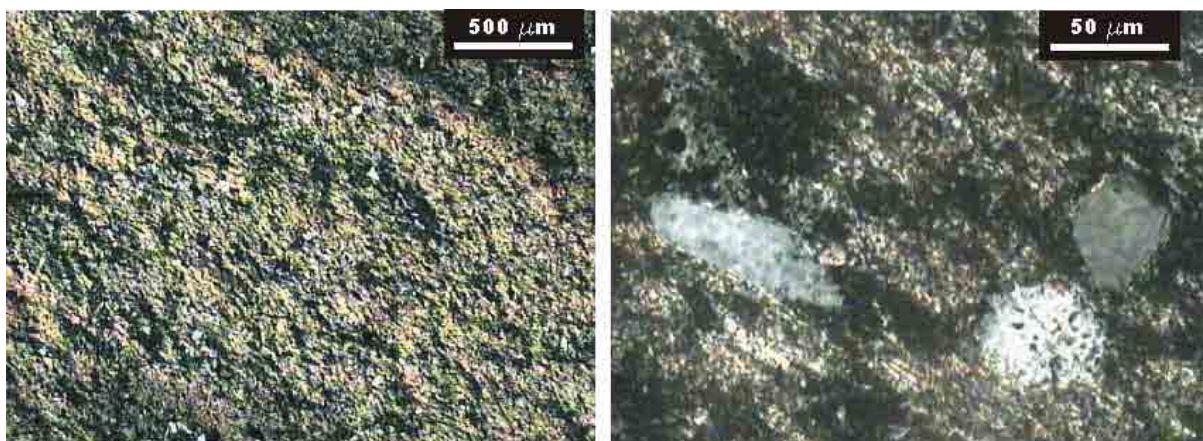
Fig. 5.18: a) Fotomicrografia de siltito roxo em que se observa predomínio matriz constituída por argilominerais onde flutuam grãos de quartzo. Nicóis cruzados, eixo maior = 2,4 mm; b) Detalhe da mesma lâmina. Observar grãos de quartzo com dimensões de 35 \mu m. Manchas escuras correspondem a chamosita, variedade de clorita rica em Fe. Eixo maior da foto = 0,24 mm.
