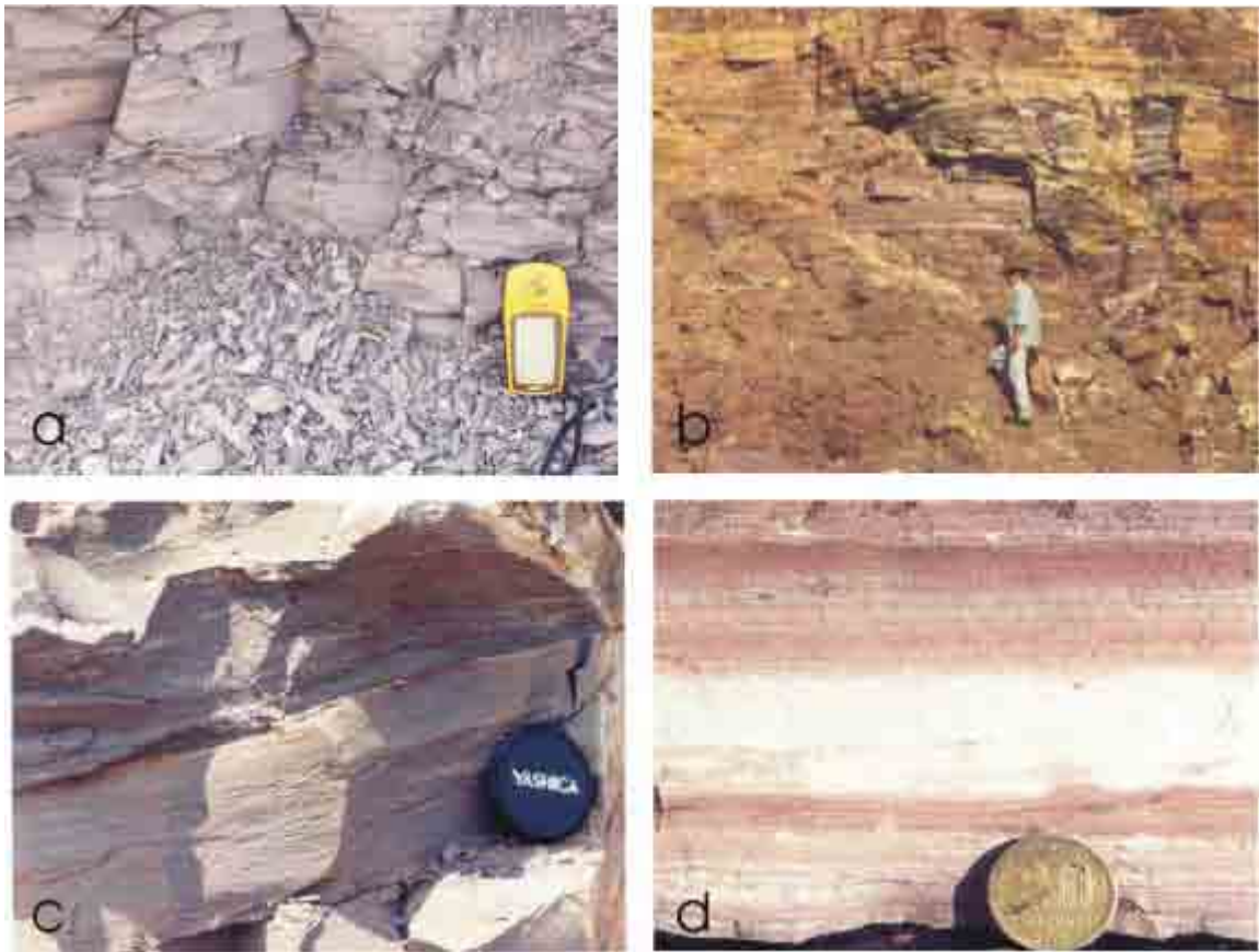
Fig. 5.1: Fotografias dos principais litotipos identificadas na área de estudos, com suas feições características. a) Os siltitos arroxeados da base da seção apresentam empastilhamento, já nos primeiros dias de exposição às condições superficiais, o que facilita a sua desagregação no pátio de secagem das minerações. GPS Garmin de doze canais utilizado como escala na foto, tirada na frente de lavra da mina de calcário de Assistência (Rio Claro) da Partecal; b) Os litotipos da porção superior apresentam interlaminanças esbranquiçadas. No conjunto esse litotipo se destaca pela coloração amarelada que assume, motivo de sua designação (Siltitos amarelados); c) O siltito roxo maciço apresenta variações de cor, que estão relacionadas ao conteúdo em matriz das diferentes camadas. Nessa foto, a parte inferior é mais clara, separada da superior por uma lâmina de material ferruginoso, muito comum nesse intervalo; d) detalhe de uma camada branca com dois centímetros de espessura intercalada nos lamitos finamente laminados, avermelhados, da porção superior, na frente de lavra da Argipar (km 9,5 da SP-127).
