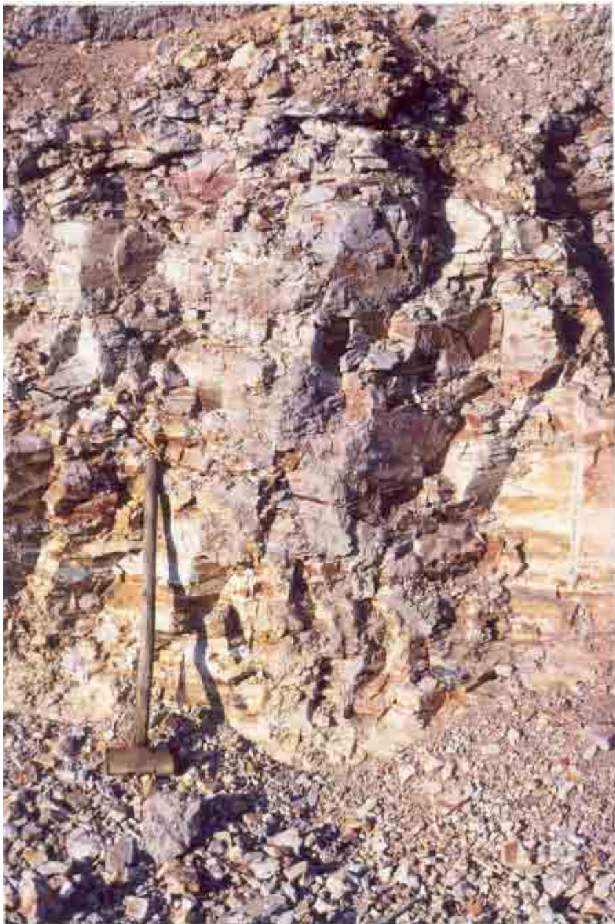
Fig. 5.15: Fotografia do Argilito violáceo na frente de lavra onde se encontra brechado. A amostra coletada para ensaios e DRX foi num local de outra ocorrência.
