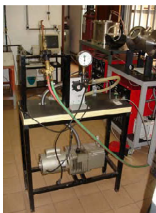
FIGURA 4 – Equipamento do Laboratório de Metalurgia Física e Solidificação do DEMA/FEM/UNICAMP utilizado para realização de vácuo.
