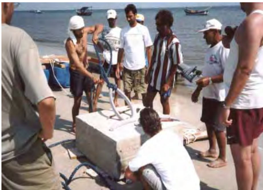
Figura 06. Poitas de fundeamento dos “long line” utilizadas no litoral do município de Ubatuba – SP.
