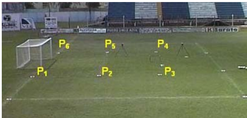
Figura 18. Imagem com os 6 pontos ( P_1 , P_2 , P_3 , P_4 , P_5 e P_6 ) gerada pela câmera 1 para obter a acurácia do teste estático.
