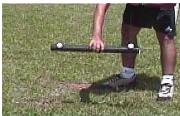
Figura 16. Imagem gerada pela câmera 2 da haste com os dois marcadores para determinar a acurácia da reconstrução tridimensional.
