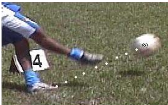
Figura 10. Procedimento de medição que possibilita obter as coordenadas bidimensionais de tela relativa às posições da bola nas seqüências de imagens geradas pela câmera 3.
