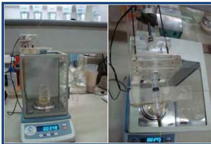
Figura 1. Sistema de produção de microfluxos e gotas para determinação da tensão superficial. Botucatu/SP 2011
