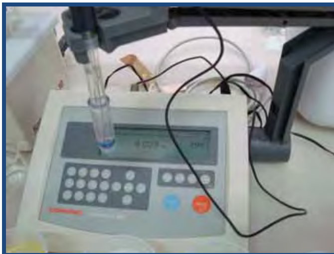
Figura 2. pHmetro de bancada do modelo Corning 450 utilizado nas avaliações. Botucatu/SP 2011.
