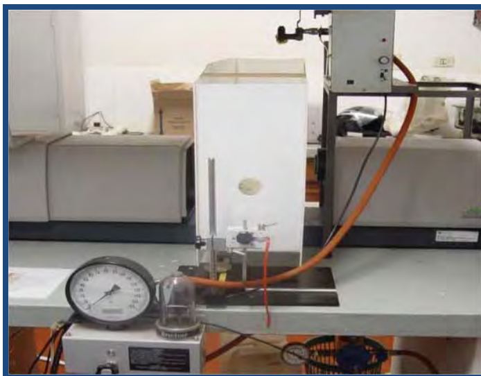
Figura 5. Sistema de laser medidor do tamanho de gotas do modelo Mastersizer. Jaboticabal/SP 2011.
