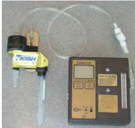
Figura 3. Fotografia do amostrador de ar NIOSH Cyclone Samplers Modelo BC 251 (CDC), acoplado à bomba de sucção de ar do tipo SKC Universal Pumps Modelo 224-44XR.
