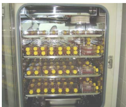
FIGURA 2 - Garrafas com fragmentos de pele em crescimento celular na estufa 38,5°C e 5% CO 2 em ar.
