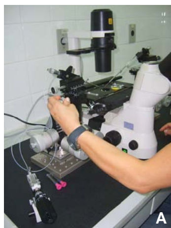
FIGURA 15 (A) - Preparação do micromanipulador para os procedimentos de enucleação; (B) – Placa de micromanipulação.
