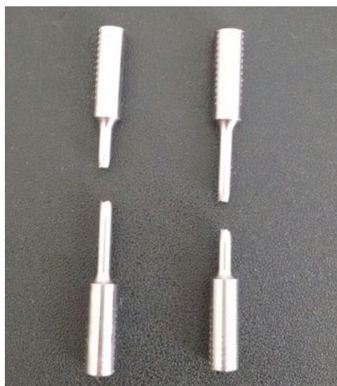
Figura 5 – Foto das amostras da liga Ti-6Al-4V após o rompimento
