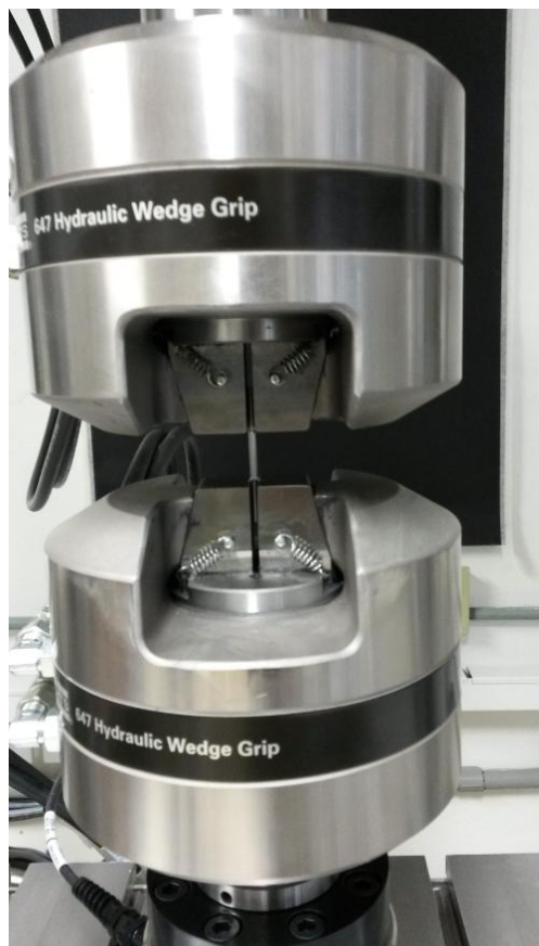
Figura 4 – Foto da fixação do corpo de prova no equipamento de ensaio de tração Bionix MTS
