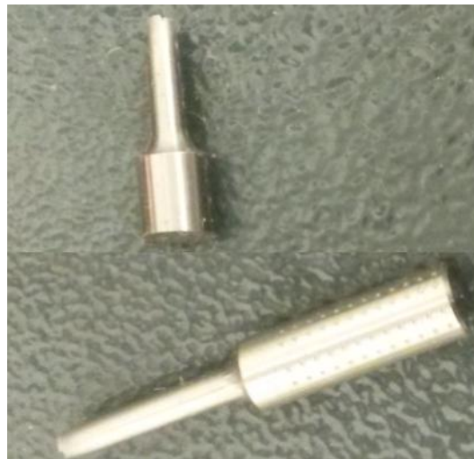
Figura 8 – Foto das amostras de Ti-6Al-4V utilizadas nos ensaios de dureza
