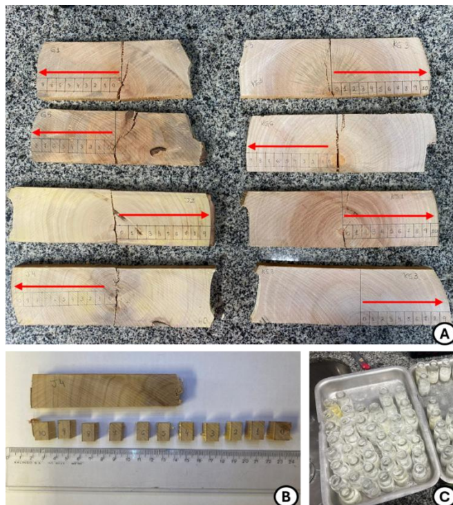
Figura 4 - Método de Franklin: A) Orientação radial; B) Corpos de prova seccionados; C) Frascos com material dissociado
