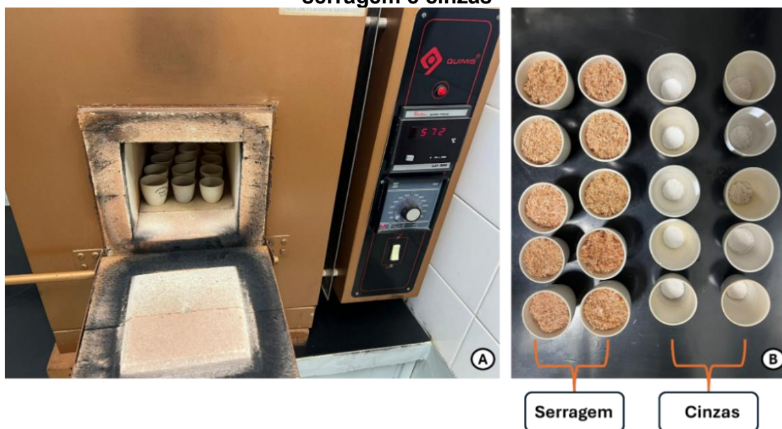
Figura 9 - Determinação de Cinzas: A) Mufla de incineração; B) Resíduos de serragem e cinzas
