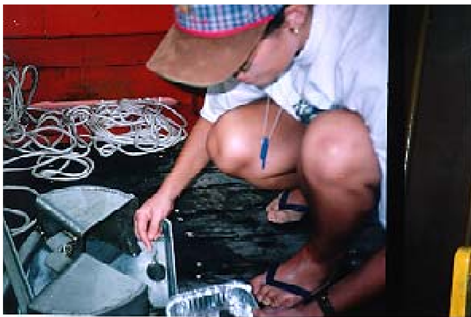
Figura 45 - Transferência de uma alíquota da amostra de sedimento para o recipiente de alumínio ("quentinha")
