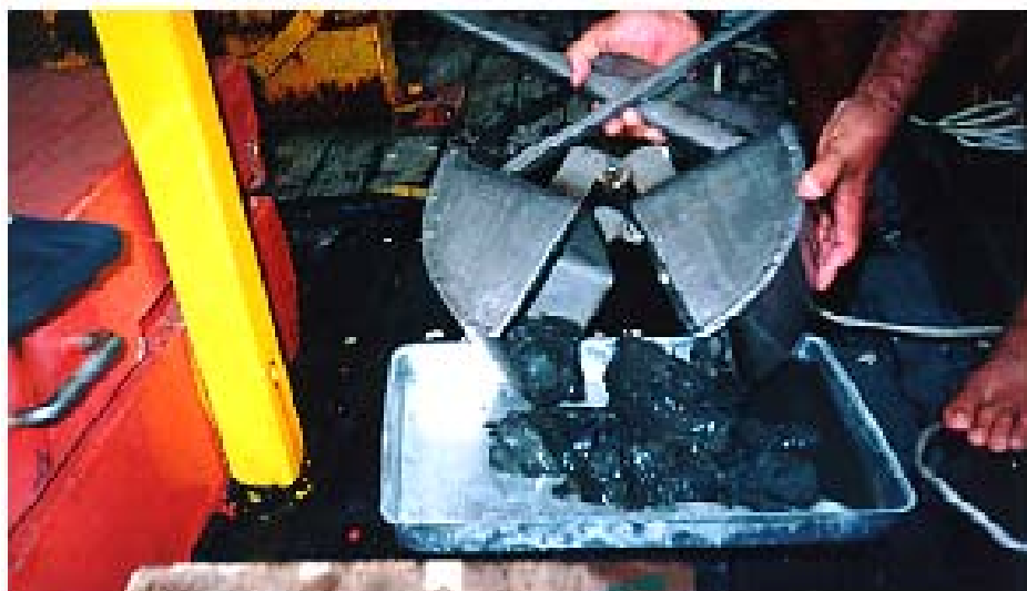
Figura 44 - Amostra de sedimento coletada pelo amostrador Pettersen modificado
