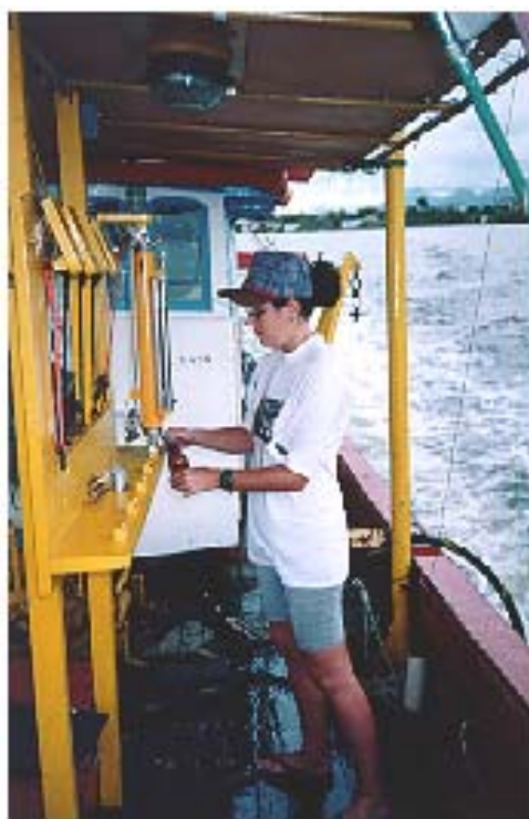
Figura 43 - Coleta de água do mar através da garrafa de Nansen, equipada com termômetros de Reversão
