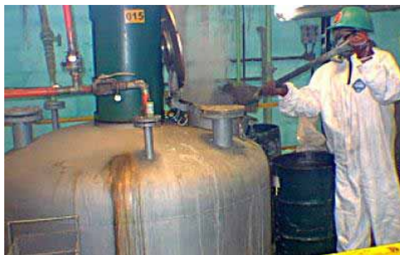
Imagem cedida pela Suzaquim Operador manipula pó químico dentro do reator
