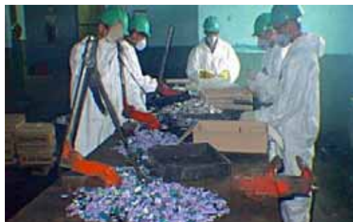
Imagem cedida pela Suzaquim As pilhas são cortadas para a separação dos vários materiais
