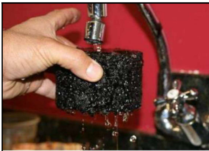
Figura 24 – Permeabilidade do asfalto poroso
