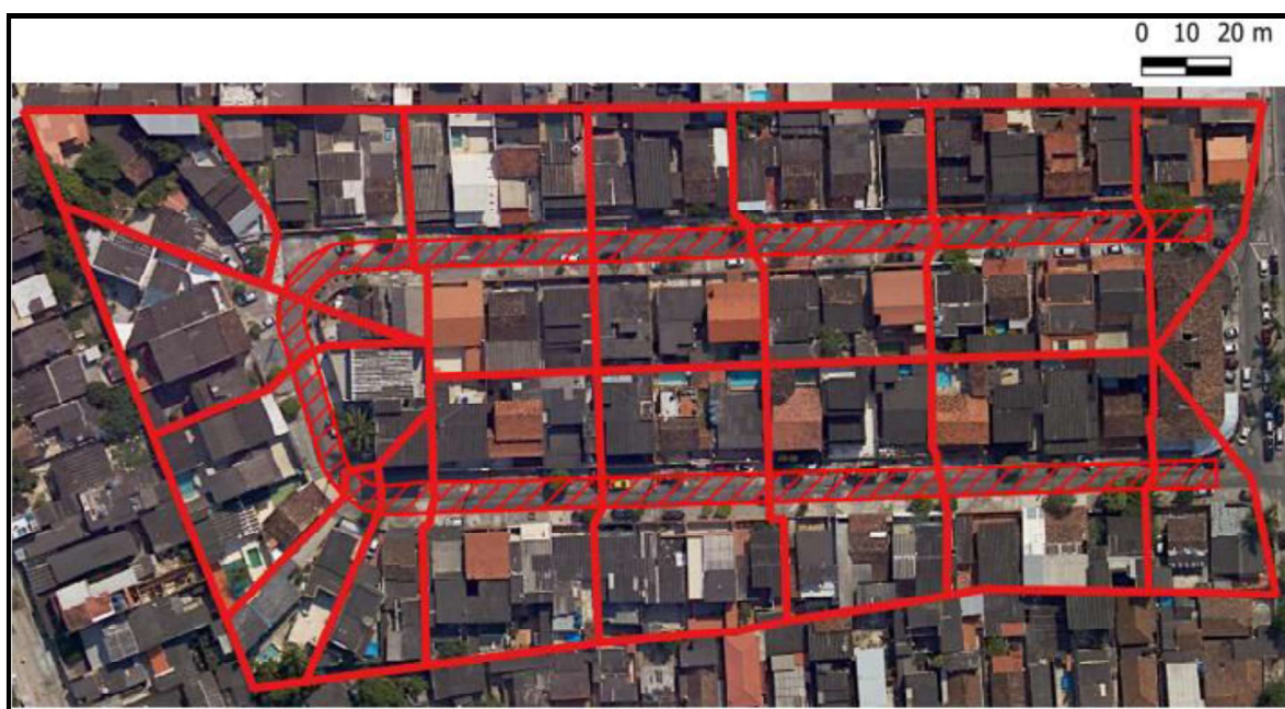
Figura 42 – Demarcação do asfalto poroso no software QGIS
