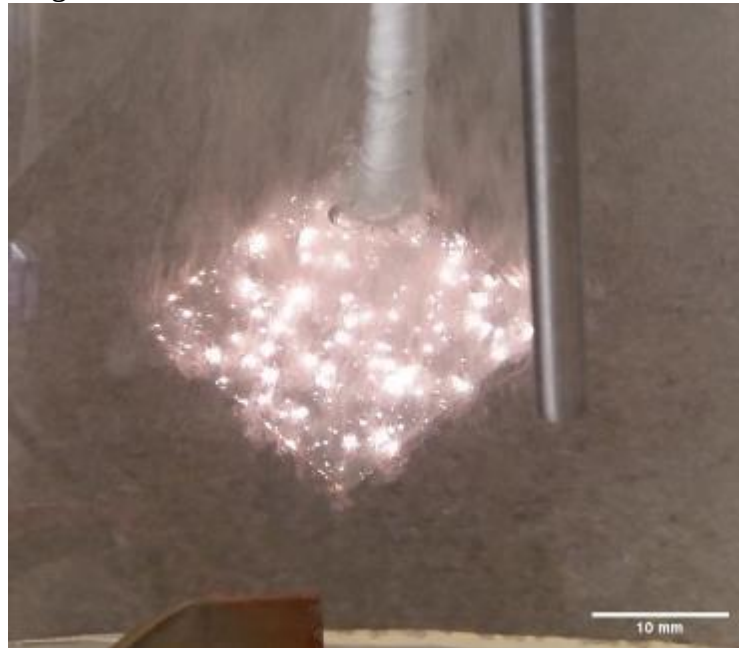
Figura 4 – Amostra de alumínio sob efeito de tratamento PEO.
