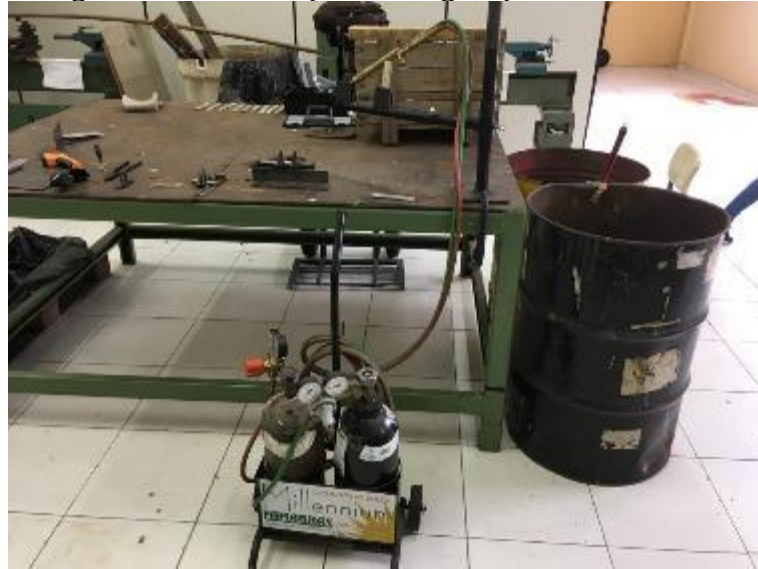
Figura 25 – Sistema para soldagem por oxi-acetileno.
