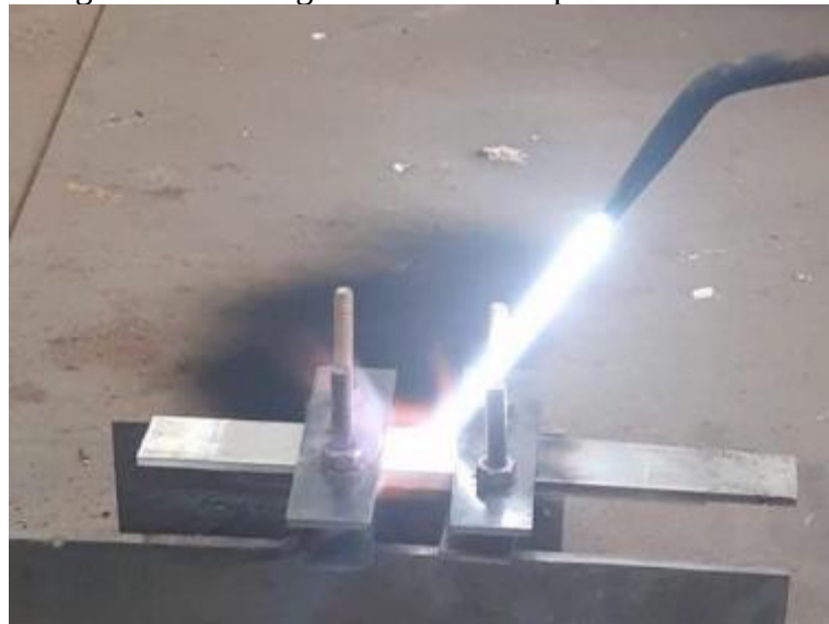
Figura 26 – Soldagem das amostras por oxi-acetileno.
