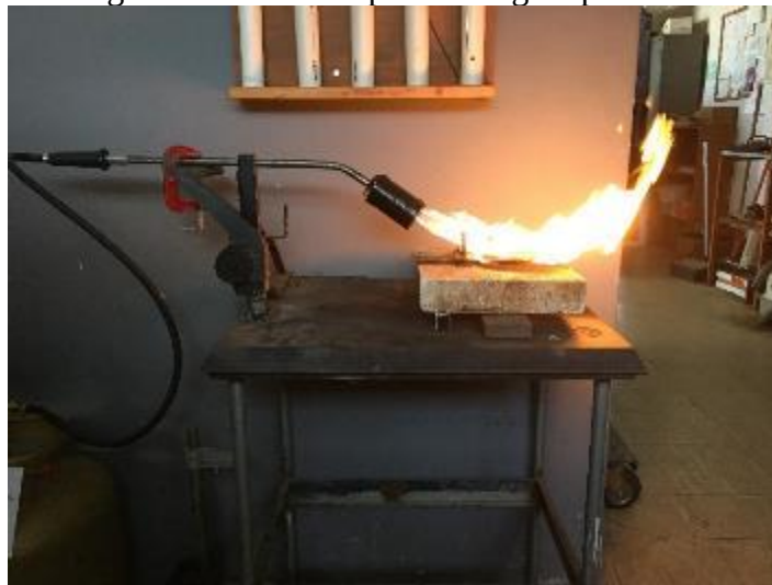
Figura 23 – Sistema para soldagem por GLP.
