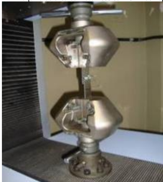
Figura 14 - Máquina de ensaios mecânicos com CDP de Lap Shear .
