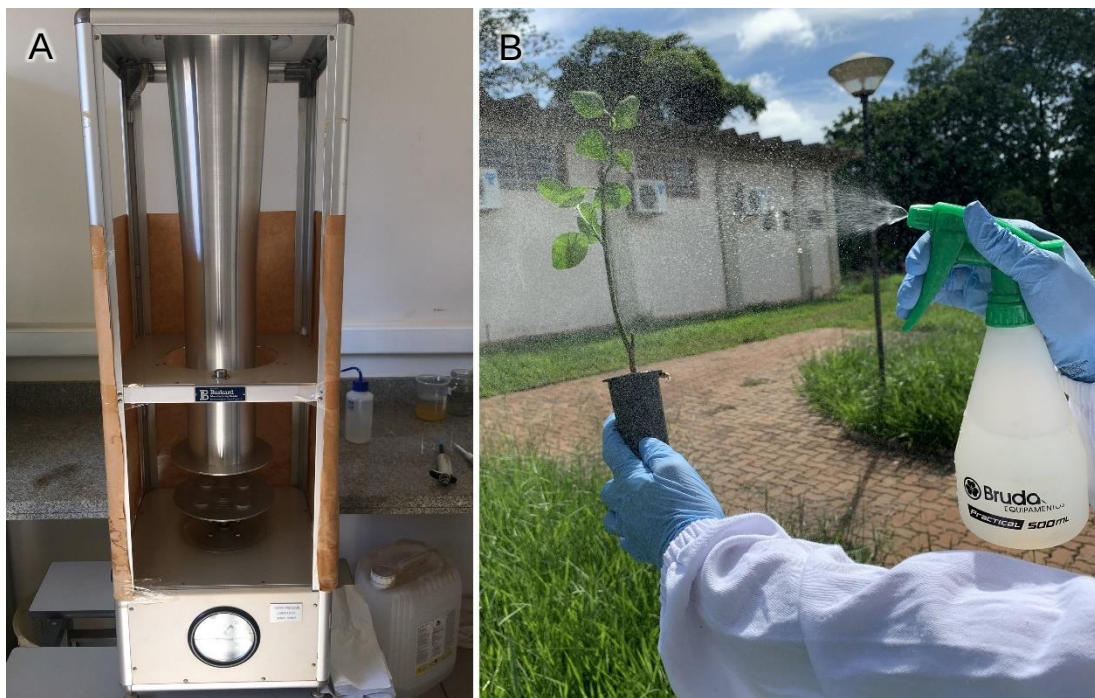
Figura 3. Equipamentos utilizados para a pulverização dos tratamentos. A) Torre de Potter (Burkard Manufacturing); B) Pulverizador manual (Bruden® Practical).
