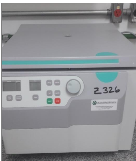
Figura 4.3 – Equipamento de centrifugação utilizado para separação do material sólido da solução.
