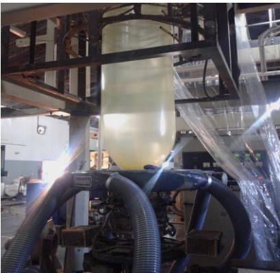
Figura 2: Produção do plástico utilizado como embalagem plástica destinada ao acondicionamento de alimentos.
