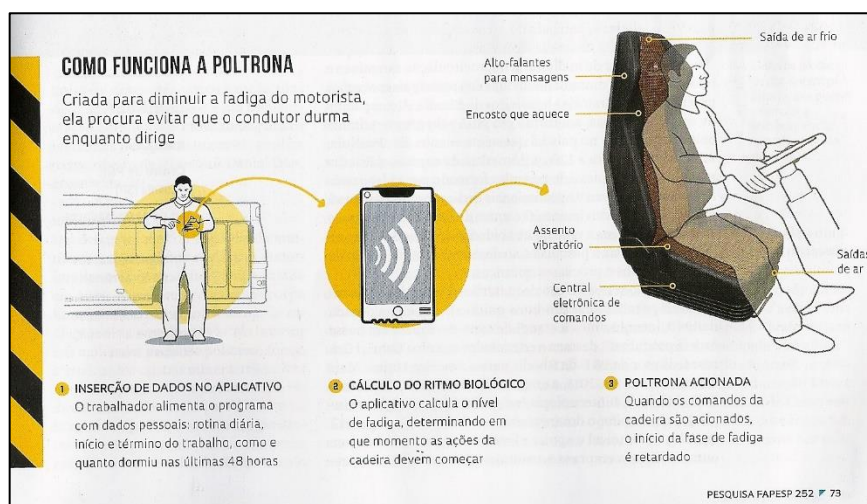
Figura 90 – Infográfico sobre o funcionamento de uma poltrona inventada para diminuir o cansaço do motorista
