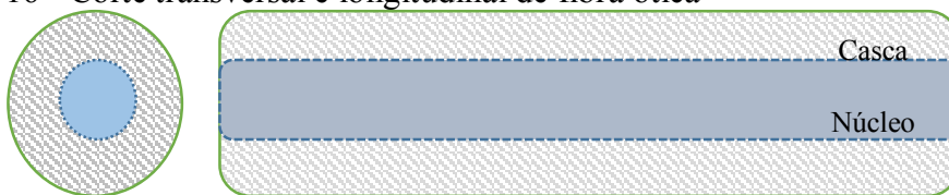
Figura 16 - Corte transversal e longitudinal de fibra ótica
