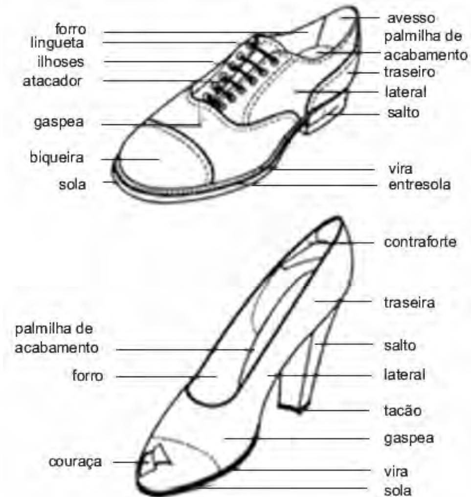
Figura 1-3 O sapato e os seus componentes
