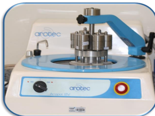
Figura 3: Politriz (Arotec Brasil) utilizada para polimento das amostras.
