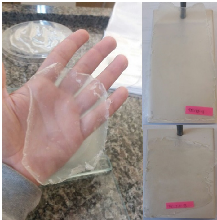
Figura 8 – Amostras confeccionada em base polimérica de amido
