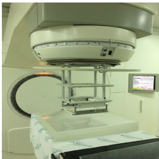
Figura 12 – Arranjo para irradiação com feixe de elétrons
