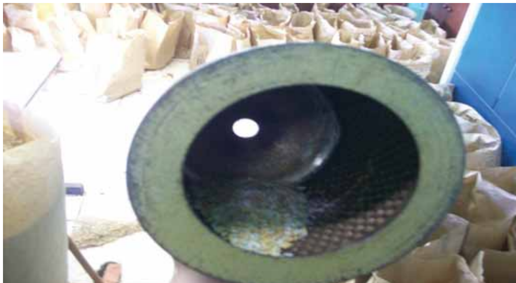
Figura 8 - Detalhe do trieur nº 2 onde os grãos foram depositados para separação dos inteiros e quebrados.
