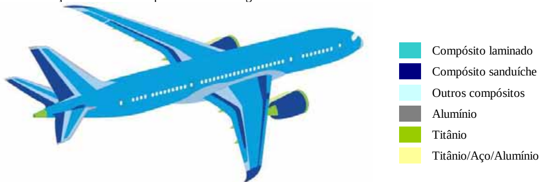
Figura 1.1 – Distribuição dos materiais aplicados no Boeing 787.
