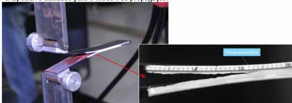
Figura 3.2 – Dispositivo utilizado para o modo I de propagação.
