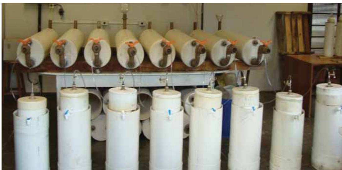
Figura 6. Vista dos biodigestores contínuos, instalados no interior do laboratório.
