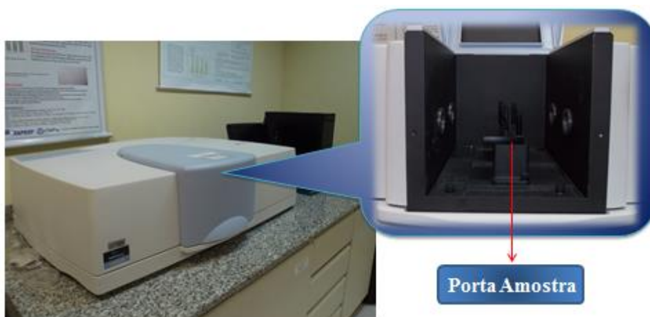
Figura 3. 8 - Fotografia do espectrômetro Uv-Vis-NIR modelo Lambda 750 da marca Perkin Elmer utilizado nas medidas de transmitância óptica.
