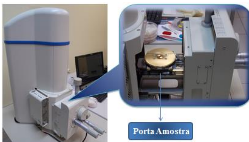
Figura 3. 7 - Fotografia do Microscópio Eletrônico de Varredura (MEV) com EDS acoplado para a identificação da composição química do material.
