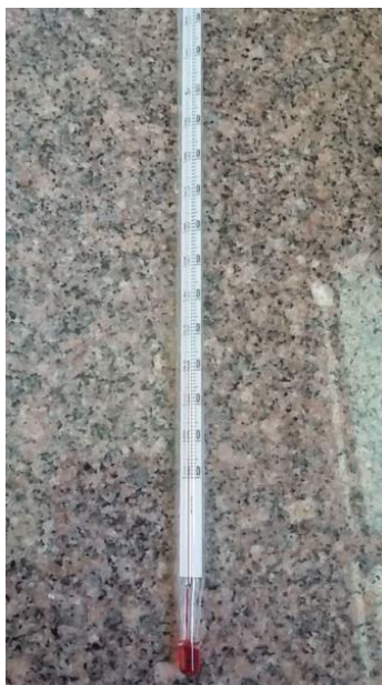
Figura 4 – Termômetro utilizado para mensurar as temperaturas da cama de frango durante o tratamento de compostagem.
