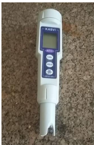
Figura 5 – Phmetro de bolso digital utilizado para mensurar o pH da cama de frango durante o tratamento de compostagem.
