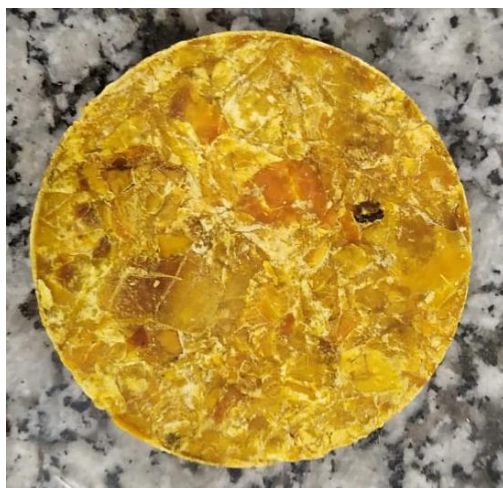
Figura 2 – Torta residual (TR) produzida por prensagem mecânica a frio.
