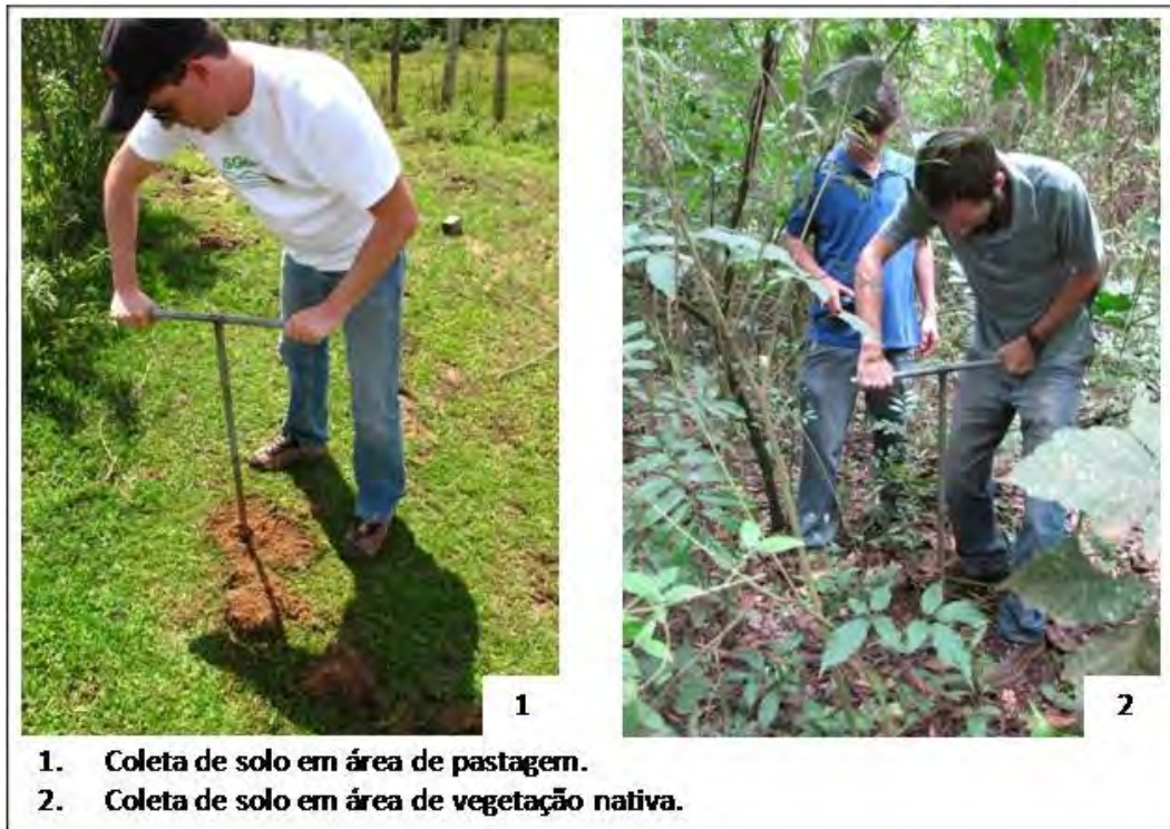
Figura 3. Tradagem para a coleta de amostras de solos na sub-bacia hidrográfica do Rio Araquá.
