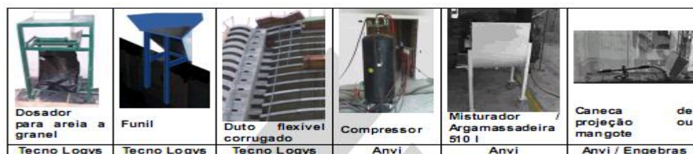
Figura 8.5 Equipamentos Utilizados Para Projeção de Argamassa (Fonte: Especificações Técnicas Gafisa – Fachada, pág. 24).
