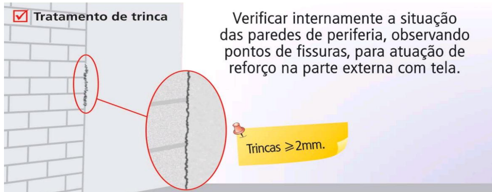
Figura 8.1 – Verificação da Situação das Paredes de Periferia (Fonte: Especificações Técnicas Gafisa – Fachada, pág. 13).
