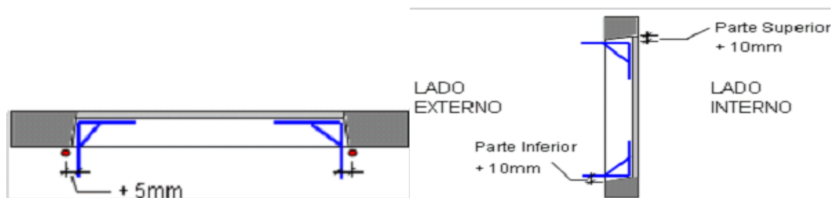
Figura 8.6 Detalhamento do Vão da Esquadria (Fonte: Especificações Técnicas Gafisa – Fachada, pág. 29).
