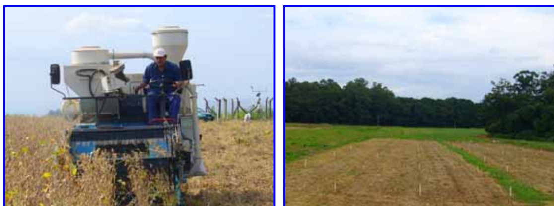
Figura 4. Detalhe da colheitadeira de parcelas automotriz marca Wintersteiger SeedMech, modelo Nursery Master Elite e área experimental após colheita da soja.
