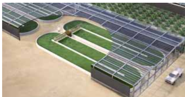
Figura 14 - Sistema aberto de cultivo de algas ("racewayponds")
