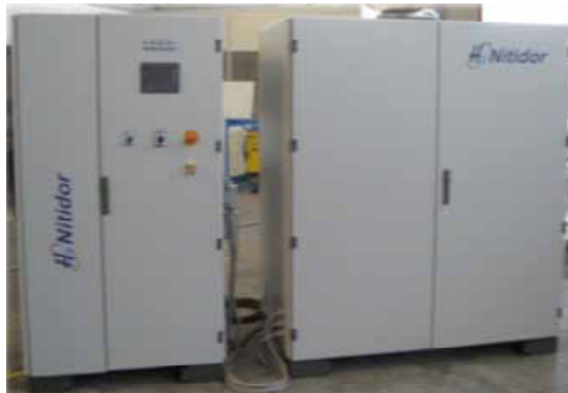
Figura 36 - O Sistema de controle (à esquerda) e o eletrolisador (à direita).
