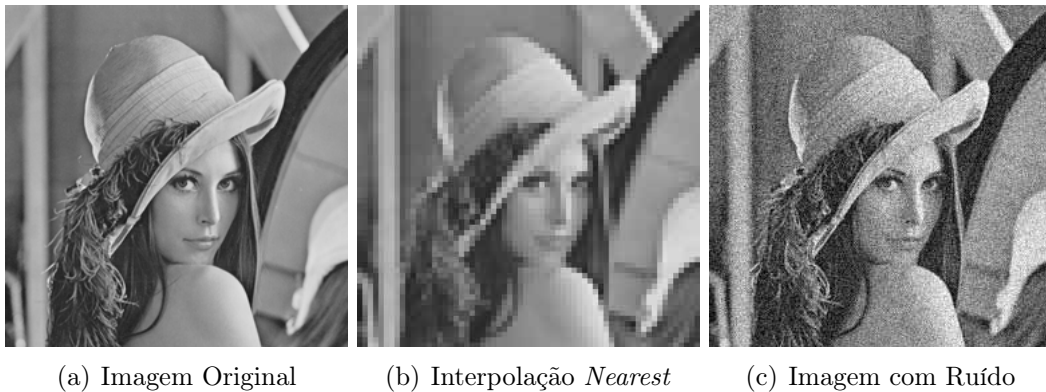
Figura 5.1: Apresentação da imagem original Lena e dois tipos de degradações distintas.
